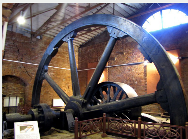
Рис. 9. Фрагмент экспозиции музея «Северская домна»: вододействующее колесо — крупнейшее из сохранившихся на Урале (диаметр 8 м, вес 65 тонн).
