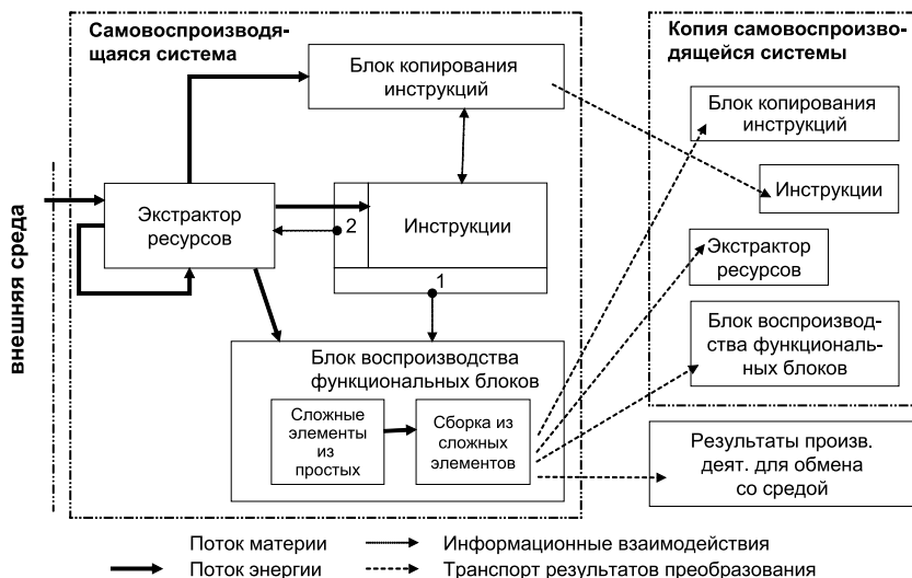
Рисунок 3.6: Модель НЕСС как модификация автомата фон Неймана
