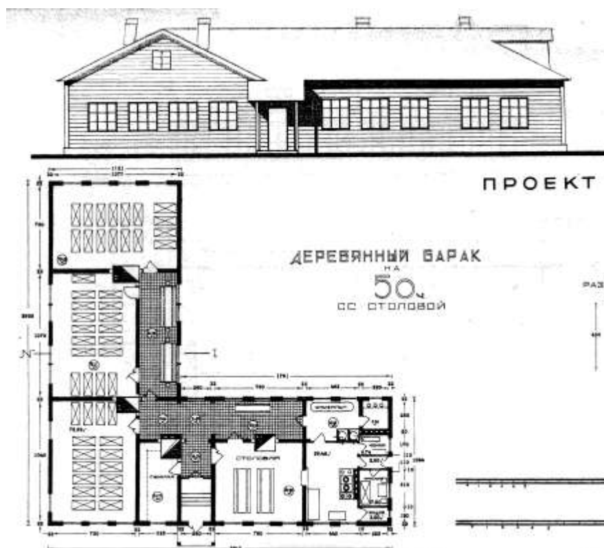
Илл. 8. Барак (одноэтажный, деревянный) на 50 человек со столовой. Проект. 1929. Источник: Проекты рабочих жилищ. Центральный банк коммунального хозяйства и жилищного строительства. М. 1929. – С.203.
