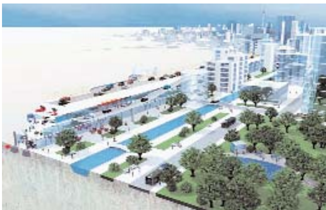
Рис. 1 Мегаструктура «ШтрассенХауз» подступает к жилым кварталам, сосредоточивая внутри себя гаражи, помещения торгового и социально-культурного назначения, а также инженерно-техническую инфраструктуру, упрятанную непосредственно под дорожное полотно.
