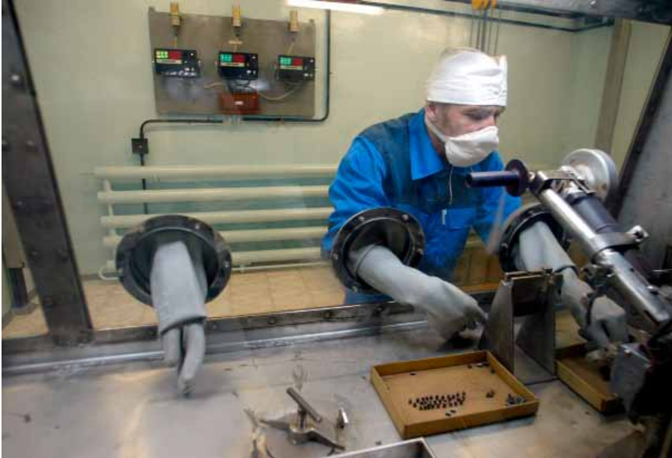
Рабочий разбавляет брикеты высокообогащенного урана
