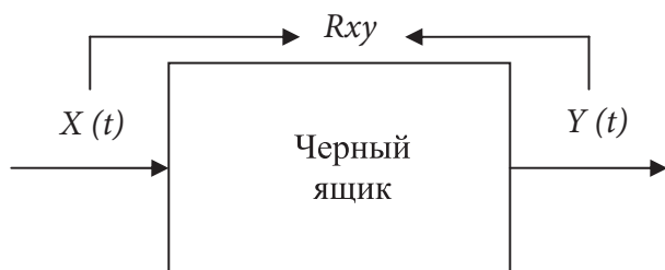
Рис. 1.24. Модель черного ящика для применения методов корреляционного и регрессионного анализа причинно-следственных связей
