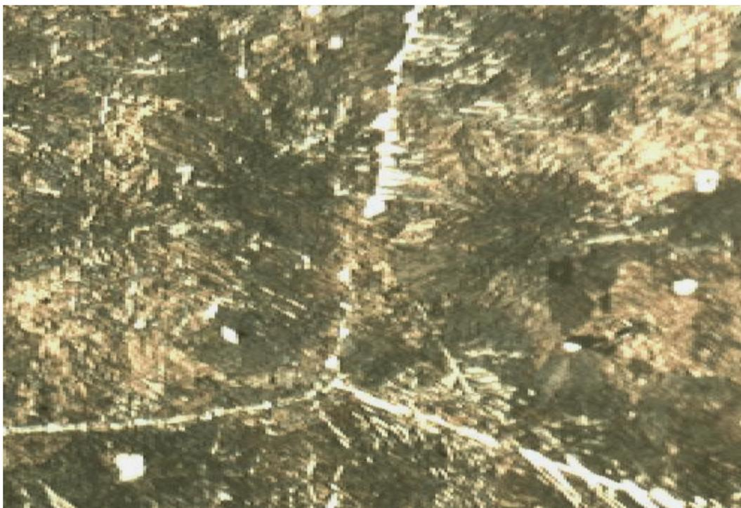
Плавка № 2754, контрольный образец. Ферритная сетка, видманштет 2–3 балла, перлитные и ферритные зерна. Увеличение  $\times 100$  крат
