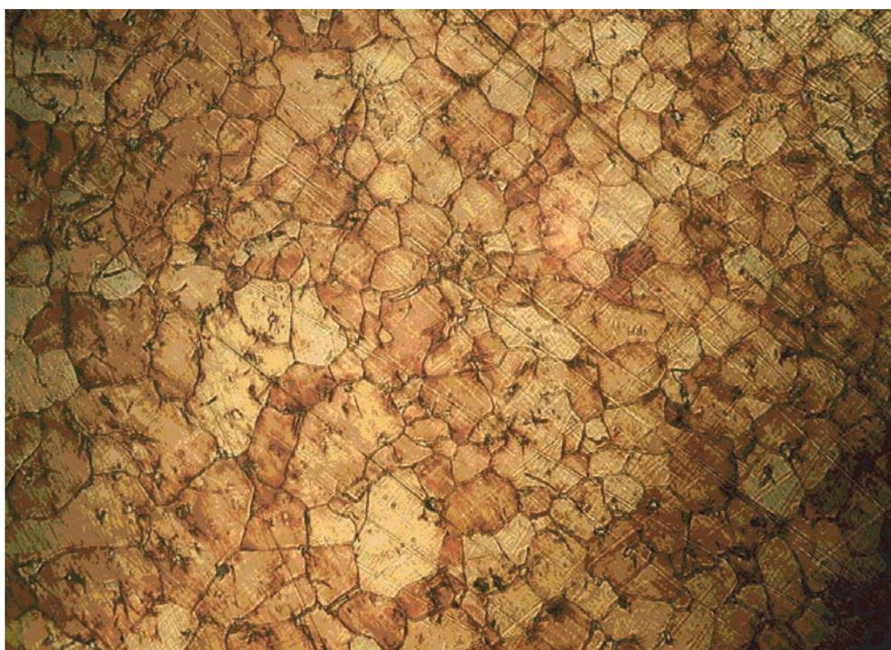
Плавка № 1817, образец, прошедший СВМ-обработку, мелкое аустенитное зерно, балл 4,5–5. Выделение карбидов подавлено. Увеличение  $\times 100$  крат
