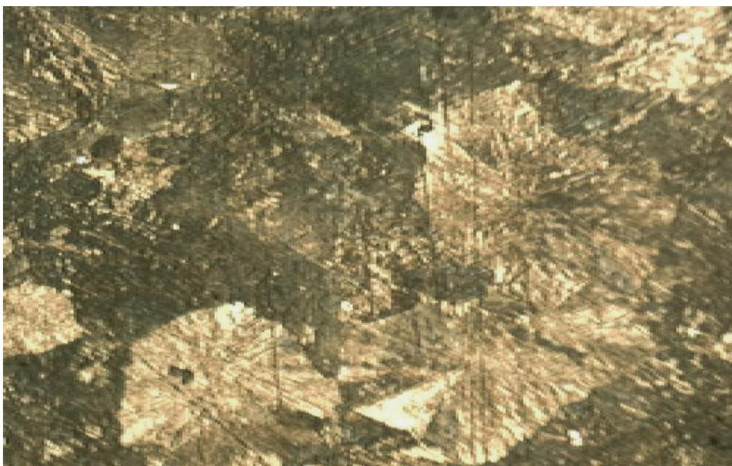
Плавка № 2755 – после волновой обработки. Ферритная сетка отсутствует, зерна феррита и перлита. Увеличение  $\times 100$  крат
